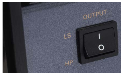
Przełącznik wyjść kieruje sygnał do kolumn albo słuchawek.
