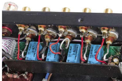
Wejścia sygnałowe obsługuje nowoczesny układ zmontowany na niezależnej płytce.
